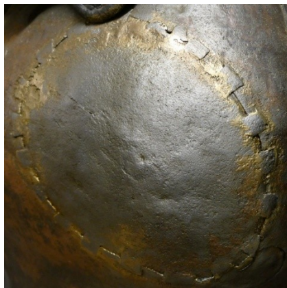
Réparation queue d'aronde sur le toupin, 1763
